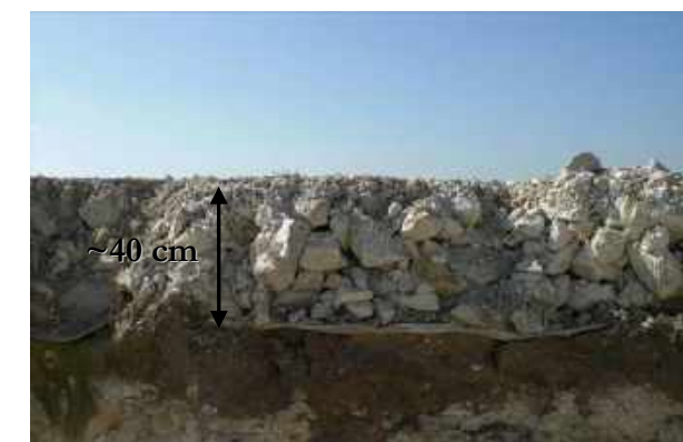
Photo 24 : Type de remblais utilisés pour le renforcement des chemins d'accès (Source : BE Jacquel et Chatillon)
