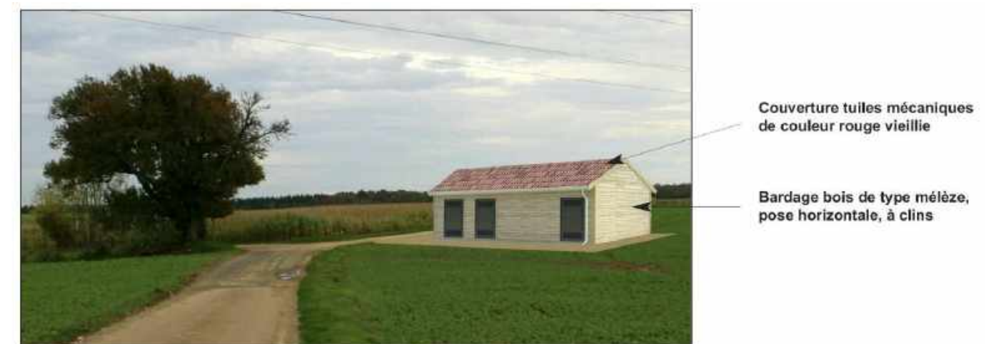
Figure 37 : Exemple de traitement des postes de livraison du projet (LIONEL JACQUEY)
