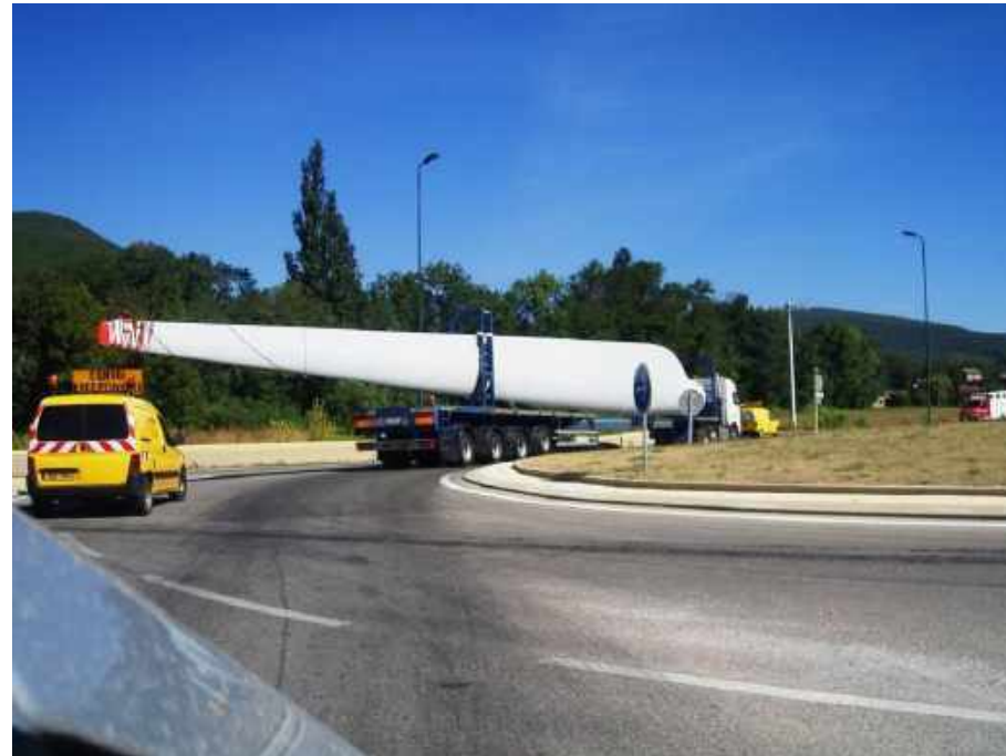
Photo 22 : Exemple de transport de pale par convoi exceptionnel (Source : VESTAS)
