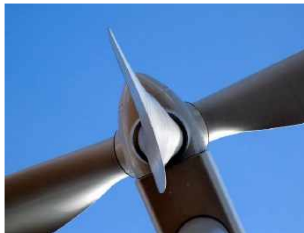
Photo 35 : Annulation de la portance des pales d'éolienne par "mise en drapeau" (Source : Larousse.fr)
