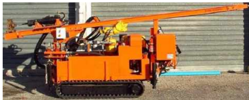
Photo 28 : Sondage de type wagon drill hydraulique (Source : FONDASOL)
